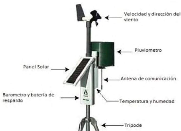
**Figura 4.** Estación meteorológica convencional
